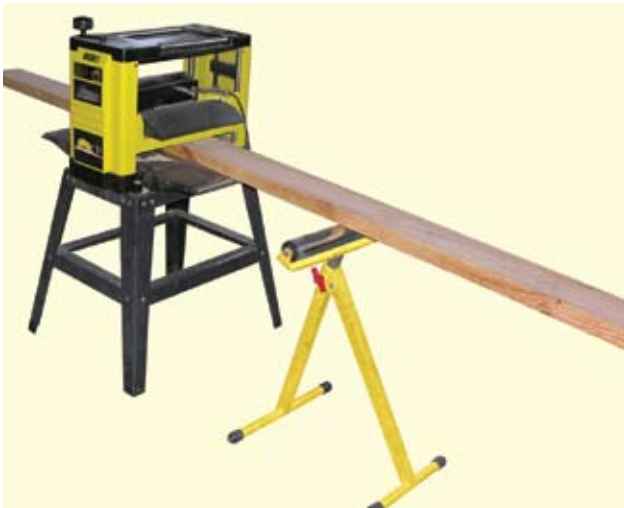
Пример использования роликовой опоры с рейсмусовым станком
