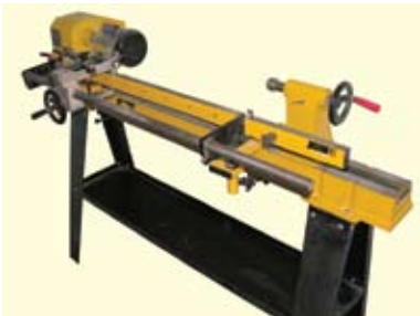
Пример крепления копира на станке
