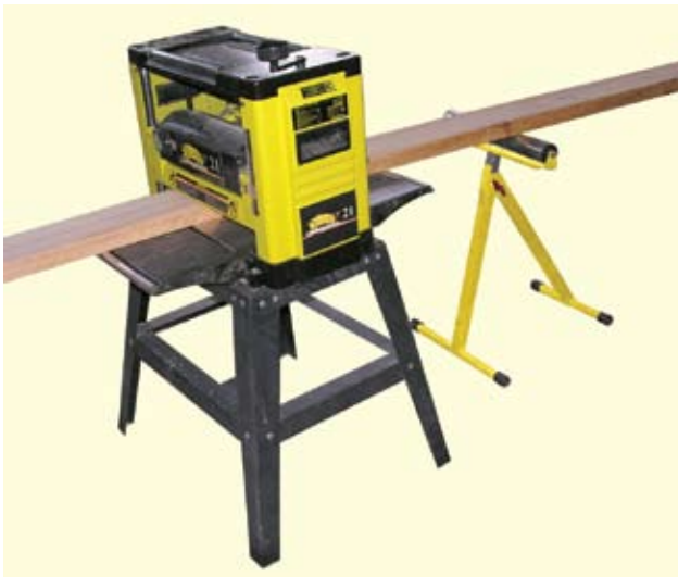
Пример использования роликовой опоры с рейсмусовым станком
