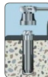
Затянуть болт или гайку с необходимым моментом
