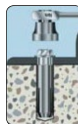
Установить элемент с необходимым моментом затяжки
